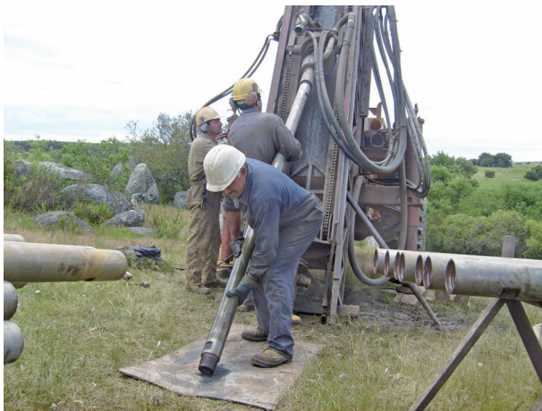
Perforaciones en el departamento de Treinta y Tres. Al finalizar la actividad y realizar la recuperación las perforaciones tienen un huella superficial de no más de 15 cm de diámetro, y son identificadas, selladas y cubiertas.
