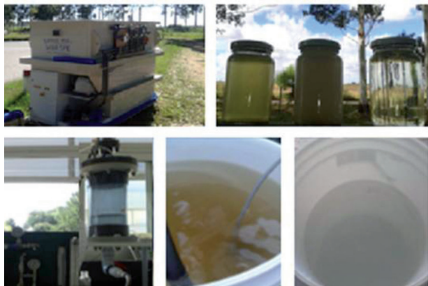
Equipos utilizados en los tratamientos de efluentes y resultados obtenidos. Arriba: Foto de reactor biológico de membrana a escala piloto, marca Almes-Eko, Croacia, y depuración lograda (derecha). Abajo: Foto de equipo ozonizador a escala piloto, marca Hydoz, Estados Unidos y depuración lograda (derecha).
