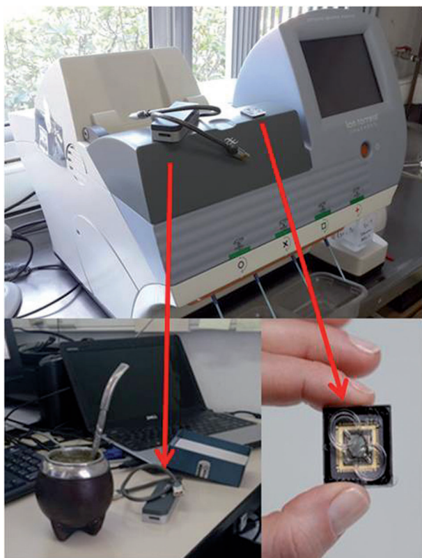
Diferentes dimensiones de lectores de ADN. Dos secuenciadores masivos en el IIBCE: el portable y de última generación (Oxford Nanopore), apoyado encima del equipo multipropósito pero de mayor tamaño, Ion Torrent PGM. Recuadro inferior izquierdo, la nueva generación de secuenciador por nanoporos se usa directamente conectado a una laptop (el mate no es necesario, solo se muestra con fines de escala ;). Recuadro inferior derecho, se muestra el chip donde se lee la secuencia del ADN dentro del secuenciador Ion Torrent (IIBCE).
