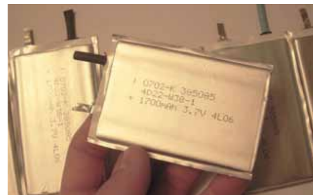
Baterías de Litio Polímero 1700 mAh - 3.7 V
